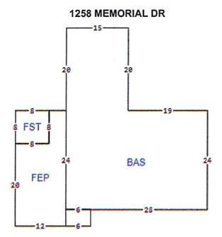
BAS=W19 N20 W15 S20 FEP=W4 FST=W8 S8 E8 N8\$ S8 W8 S20 E12 FOP=E6 N4 W6 S4\$ N4 N24\$ S24 E6 E28 N24\$.
